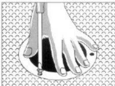
Figure 9 – Raccordement du revêtement au siphon
